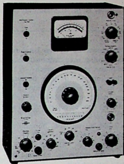
Fig. 32. De toongenerator B & K type 1022.
